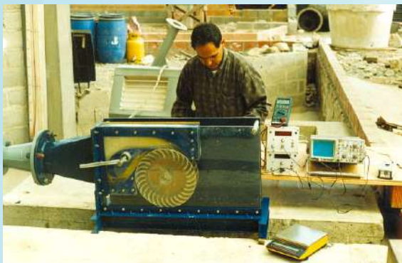
Figuras 9 y 10. Modelo de turbina Banki testada en el banco de pruebas del IHH. Fuente: Prog. Hidroenergía. IHH- UMSA
