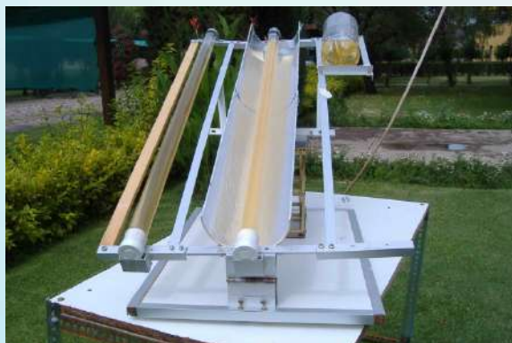
Figura 3. Dispositivo soportando tres reactores en pleno proceso de foto-reacción
