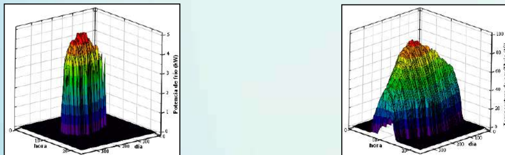
Figura 2. (Izq.) Potencia horaria de frío (kW) a lo largo de un año. (dech.) t_{eq} . ( t_e=5^\circ\text{C} )
