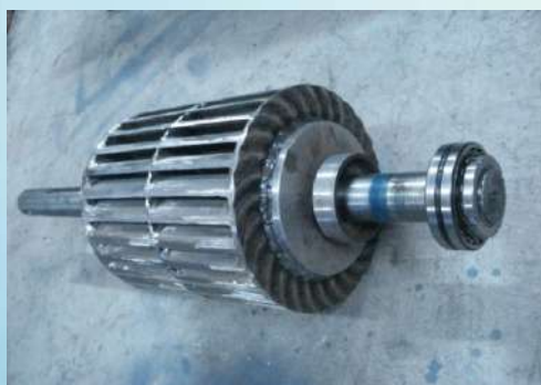
Figura 11. Rotor de turbina Banki. Cuenta con 28 álabes de acero inoxidable, diámetro externo del rotor de 22 cm. y un disco intermedio para impedir la flexión de los álabes. Fabricado para el proyecto Microcentral Hidroeléctrica Palmeras. Provincia Sud Yungas del Departamento de La Paz. Fuente: Prog. Hidroenergía. IHH-UMSA
