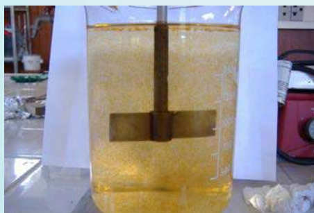
Figura 6. Flóculos formados (Índice de Willcomb de 6-8) con agitación controlada a 33 \text{ s}^{-1} de gradiente de velocidad con agua de pozo contaminada artificialmente con As(V).
