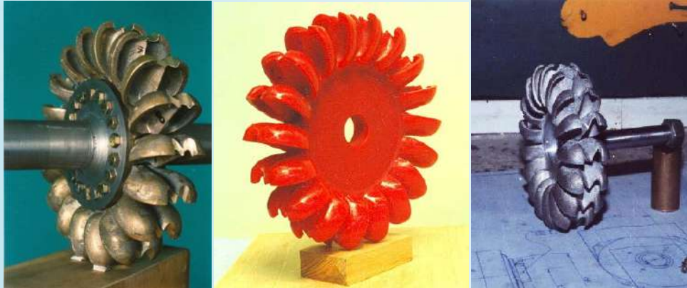
Figuras 1, 2 y 3. Rotores de turbinas Pelton de bronce, poliuretano rígido y aluminio fabricados en el ihh. Fuente: Prog. Hidroenergía. IHH-UMSA
