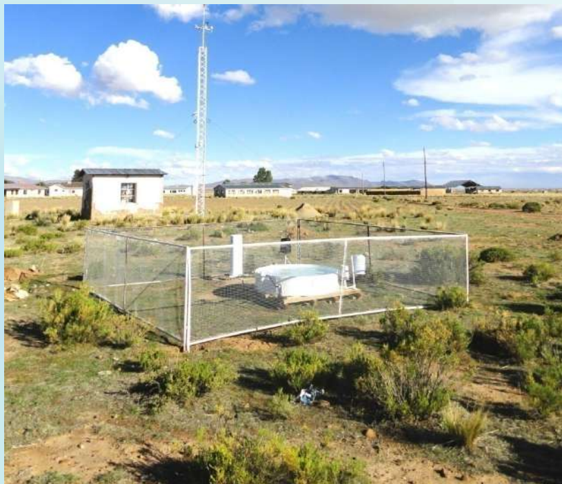
Figura 1. Estación Meteorológica de Patacamaya. En primer plano los sensores de evaporación y precipitación, y al fondo la torre con los sensores principales, la caja de control y la caseta de monitoreo.
