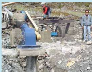
Figuras 33, 34 y 35. Molino para minería tipo Trapiche impulsado con energía hidráulica (izq). Productos alimenticios procesados, café y locoto molido. Proyecto Camata (centro). Deshidratado de frutas. Proyecto Charía (der.).
