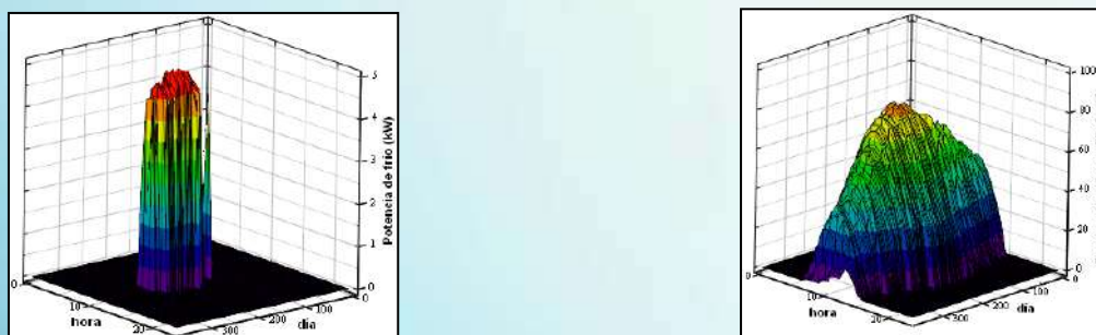
Figura 3. (Izq.) Potencial horaria de frío (kW) a lo largo de un año. (dech.) t_{eq} . ( t_e=14^\circ\text{C} )
