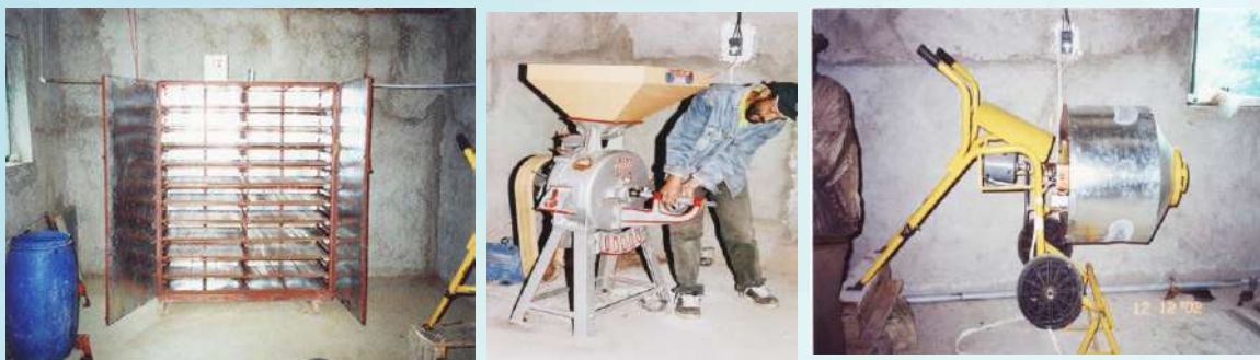
Figuras 24, 25 y 26. Horno de secado de locoto (izquierda), molino de café y cereales (centro) del proyecto Camata y tostadora eléctrica de café (derecha) del proyecto Charia. Fuente: Prog. Hidroenergía. IHH- UMSA
