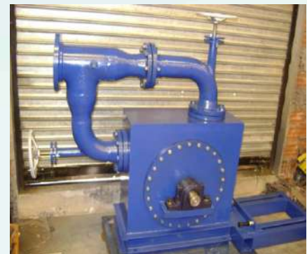
Figuras 6, 7 y 8. A la izq. Turbina Pelton con inyector tipo caracol y dos toberas de accionamiento externo, al centro corte transversal y a la derecha turbina fabricada, nuevo desarrollo de turbinas Pelton. Fuente: Prog. Hidroenergía. IHH-UMSA
