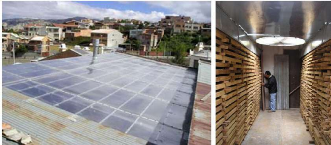
Figura 4 (a – b). Secador solar de madera de 5.000 pies (= 11,79 m 3 ) de capacidad, instalado en la ciudad de La Paz. Para madera de con espesores encima de las 2 pulgadas (= 5 cm) se necesitan más de 60 días para el proceso de secado (especie: roble). Izquierda: Techo – colector. Derecha: Cámara de secado. Fuente: ECOENERGÍA FALK S.R.L.
