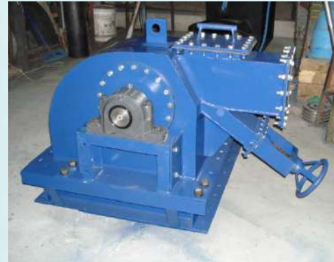
Figura13. Turbina Banki fabricada para el proyecto caudal MCH Quinuni, Prov. Sud Yungas. La Paz. Fuente: Prog. Hidroenergía. IHH- UMSA
