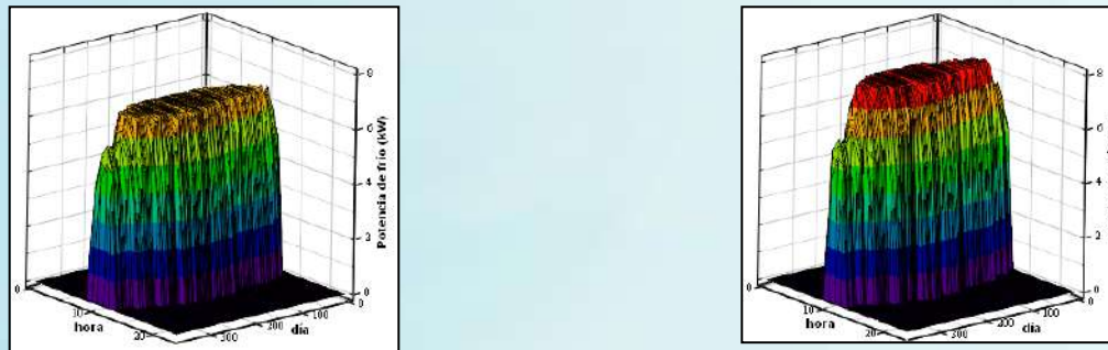
Figura 4. (Izq.) Potencia horaria de frío (kW) a lo largo de un año. (dech.) t_{geq} . ( t_e=5^{\circ}\text{C} , con una relación muy alta \Psi=200 ).
