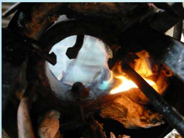
Fotografía 1. Quemador CUNOC IID. Vista inferior y fusión de fibra de vidrio. Fuente: González
