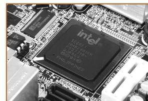
tarjeta llamada MotherBoard conocida en español como "tarjeta madre" la cual es una tarjeta de circuitos en donde se une con los demás componentes del CPU.
