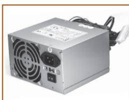
La fuente de poder es el alimentador de energía eléctrica para todo el CPU, que con la ayuda del Motherboard la regula para los diferentes componentes conectados a él.
