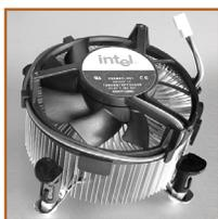
El procesador necesita un ventilador que le ayuda a no sobrecalentarse, dicho ventilador está en la parte posterior del procesador, va pegado a él y dependiendo del procesador es el tipo de ventilador que utiliza, lo único que cambia es el tamaño.
